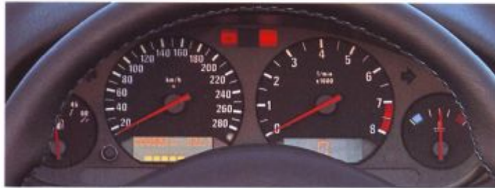
Die sportlichen Analoginstrumente sind auch nachts gut ablesbar: dank moderner Durchlichttechnik.
