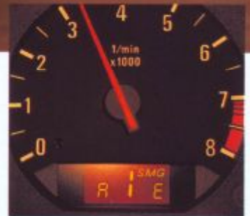
Schalten ohne zu kuppeln: mit dem Sequentiellen M Getriebe (SMG).
