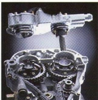
Auf der Welt einzigartig: die multivariable Nockenwellensteuerung (VANOS). Sie sorgt für einen optimalen Drehmoment-
