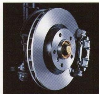
Die neuen 17-Zoll-Aluminium-Gußräder der M3 Limousine erlauben den Einbau von besonders groß dimensionierten, innenbelüfteten Brems-
