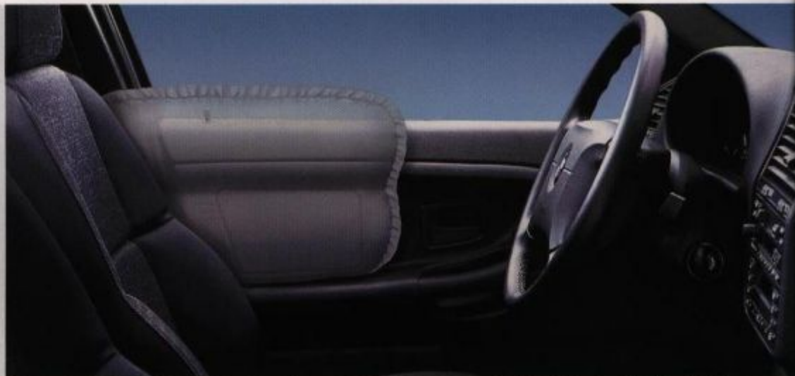
Der serienmäßige Seitenairbag verringert das Verletzungsrisiko bei einer seitlichen Kollision für den Brustbereich erheblich.
