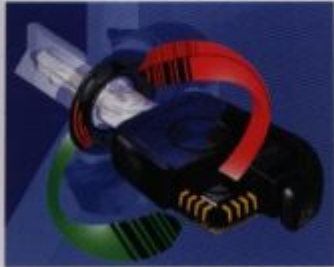
Die elektronische Wegfahrsperrung (EWS): Eine doppelte, elektronische Codierung im Schlüssel schützt vor unbefugtem Starten.
