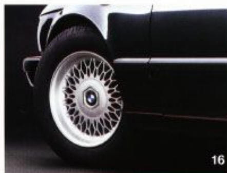
16 TD-Rad. Elegantes Leichtmetallrad mit Notlauf-eigenschaften. Das Sicherheitssystem wurde entwickelt, um auch im Falle eines Reifendefekts die nächste Tankstelle oder Werkstatt anfahren zu können. Dabei sind Geschwindigkeiten bis zu 60 km/h möglich.
