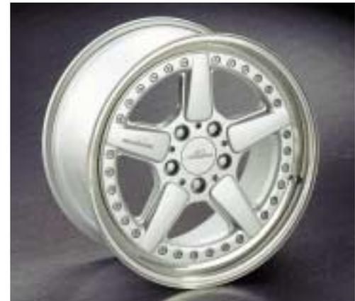
AC Schnitzer Rennsportfelge Typ II, silber mit poliertem Außenbett in den Größen 8,0 J x 17" bis 9,0 J x 18". *AC Schnitzer racing alloys Type II, silver with polished outer bed in sizes 8.0 J x 17" to 9.0 J x 18".*
