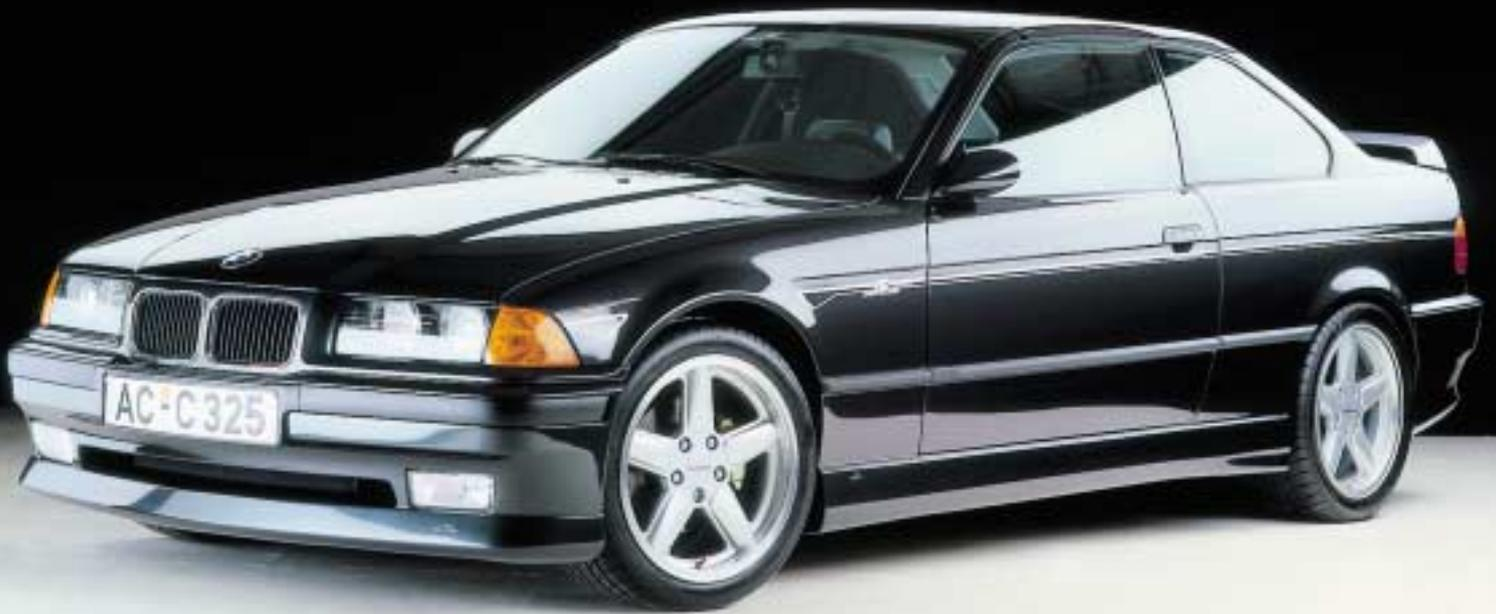
Für alle 3er Modelle hat AC Schnitzer auch ein umfassendes Programm mit Sport- und Rennsportfahrwerken entwickelt, die zum Teil in der Höhe verstellbar sind. Alle Fahrwerke sind sportlich-komfortabel auf das jeweilige Fahrzeug individuell abgestimmt und ermöglichen Tieferlegungen von 30-40 mm. Speziell entwickelte Stabilisatoren und Federbeinbrücken komplettieren das AC Schnitzer Fahrwerksprogramm.
