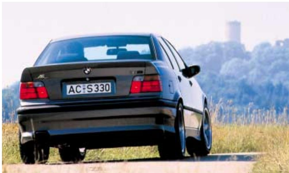
Das Heck der Limousine mit AC Schnitzer Aerodynamik Typ II mit Heckspoiler (oben) und Heckschürze (rechts).
